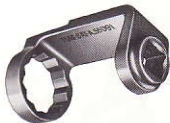
A. 55091 Bussola per manovra dado del pignone conico e per controllo coppia di rotolamento.
