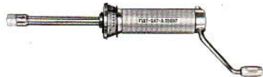
A. 95697 Dinamometro per misurare la coppia di rotolamento dei cuscinetti.
