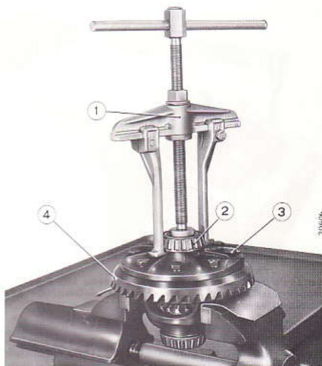
Estrazione anelli interni cuscinetti a rulli per scatola interna differenziale.
