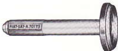
A. 70173 Battitoio per montaggio anello esterno cuscinetto anteriore su pignone conico.
