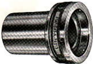
A. 74213 Attrezzo per montaggio alla pressa della ghiera di ritegno cuscinetto sull'albero differenziale.
