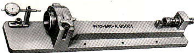
A. 95601 Attrezzo per prova carico di sfilamento ghiera ritegno cuscinetto sull'albero differenziale.
