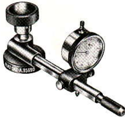
A. 95690 Comparatore con supporto, da usare con A. 70222 , per determinazione spessore anelli di registro (appoggio) pignone conico.
