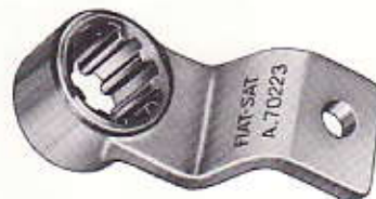
A. 70223 Attrezzo per ritegno pignone conico alla chiusura del relativo dado.
