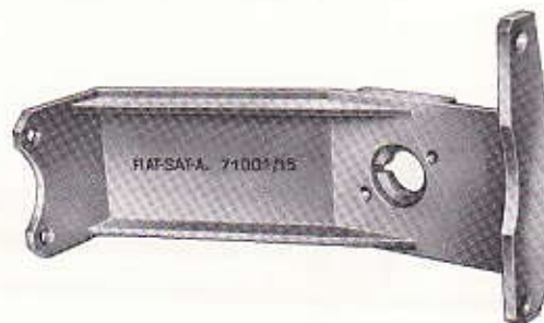
A. 71001/15 Supporto sostegno differenziale durante la revisione, da applicare al cavalletto rotativo Ar. 22204 .
